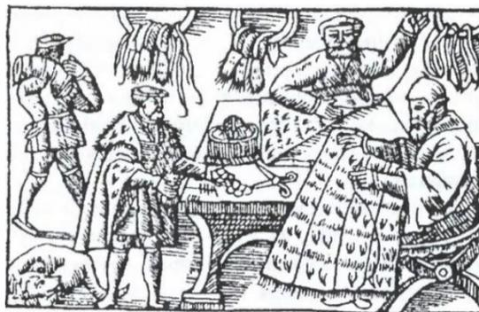
Рис. 5. Скорняжная обработка мехов (по Олаву Магнусу). Видны кольцевые бунты, мешки козицы и сшивание отдельных шкурок в большие полотна.
