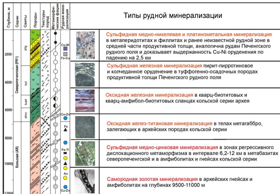
Рис. 7. Вертикальная рудная зональность в разрезе СГ-3 [10].
