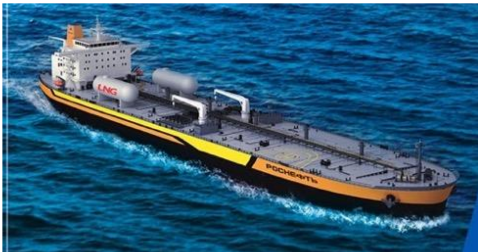
Нефтеналивное судно типа «Афрамакс» проекта 114К дедвейтом 114 тысяч тонн.
